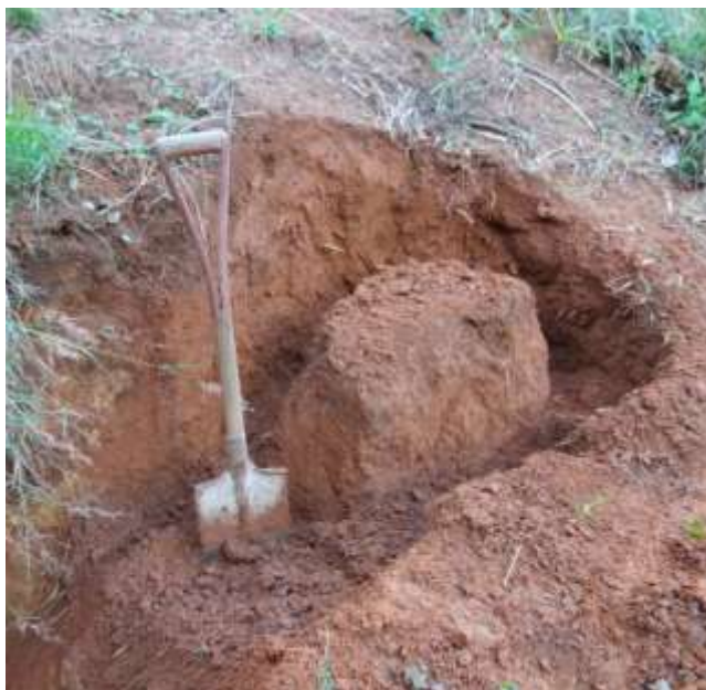
Figura 34 – Escavação para retirada de corpo de amostra indeformada de solo
