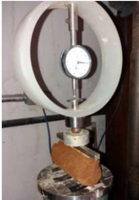
Figura 40 – Corpo de prova submetido à compressão diametral
