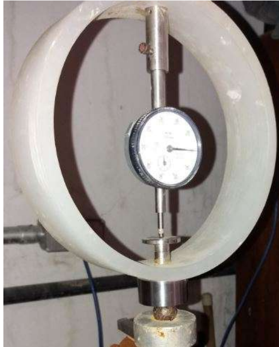
Figura 38 – Anel de Nylon e Relógio comparador para medir deflexões.
