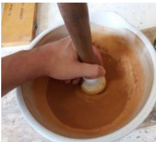
Figura 35 – destorroamento da amostra de solo seco para análise granulométrica
