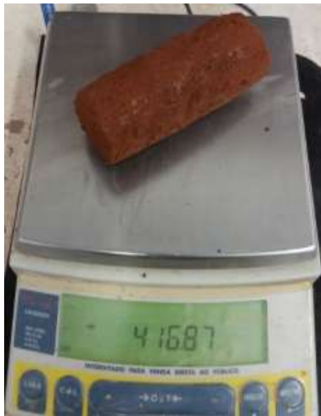
Figura 37 – Pesagem de corpo de prova de volume conhecido
