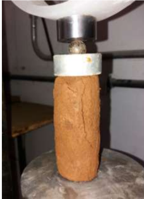
Figura 39 – Corpo de prova rompido no ensaio de compressão simples
