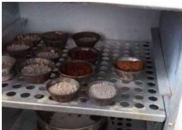
Figura 36 – Estufa mantida em 60°C para secagem de amostra
