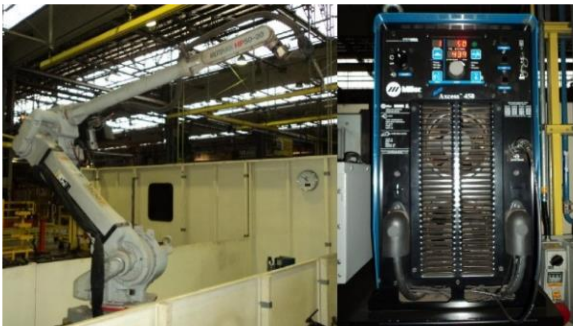
Figura 3.4 – Robô MOTOMAN HP50-20 e fonte de potência Miller Auto-Access450.
