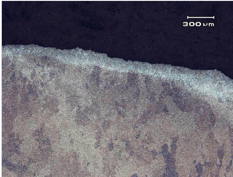
Figura 4.22 – Metalografia amostra CP3-2, região 1, mostrando propagação de trinca pela ZTA.
