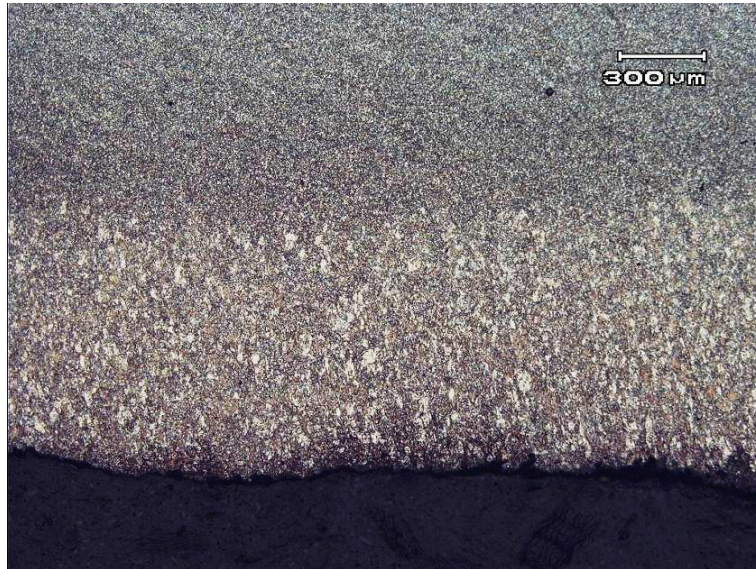
Figura 4.14 – Metalografia amostra CP1-3, região 2, mostrando propagação de trinca pela ZTA.
