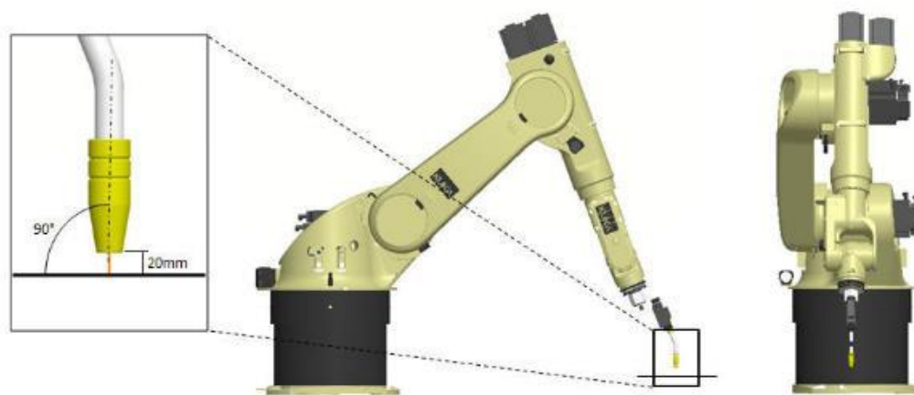
Figura 3.8 – Posição da tocha de soldagem em relação ao eixo do cordão de solda.
