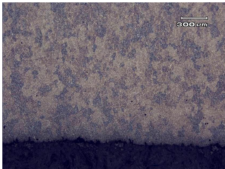
Figura A.11 – Metalografia amostra CP2-2, região 1, mostrando propagação de trinca pela ZTA
