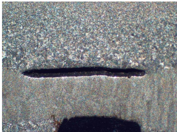
Figura A.9 – Metalografia amostra CP4-3 mostrando superfície da fratura na região
