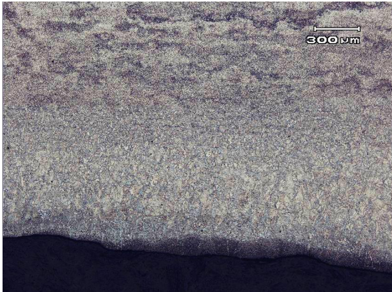
Figura 4.17 – Metalografia amostra CP2-3, região 1, mostrando propagação de trinca pela ZTA.
