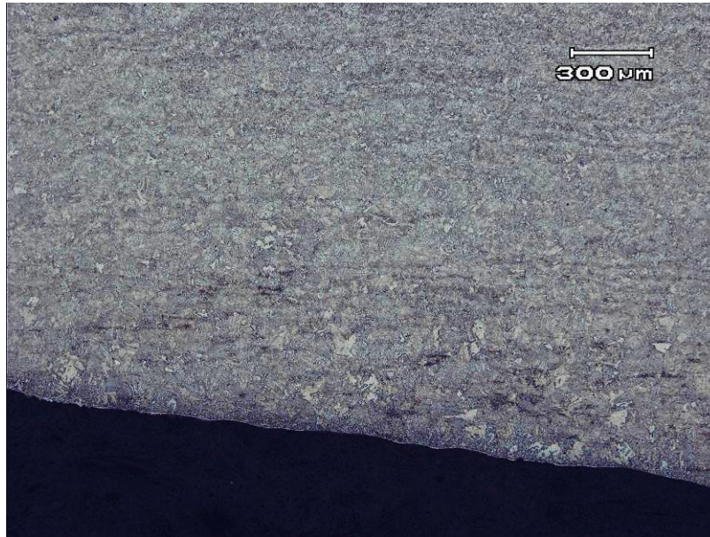
Figura 4.24 – Metalografia amostra CP3-2, região 2, mostrando propagação de trinca pela ZTA.
