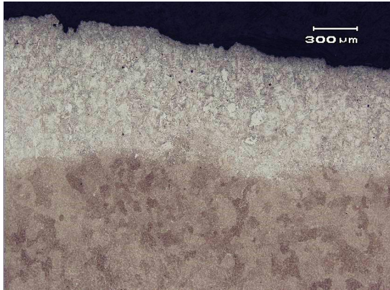
Figura 4.19 – Metalografia amostra CP2-3, região 2, mostrando propagação de trinca pela ZTA.
