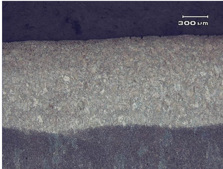
Figura 4.12 – Metalografia amostra CP1-3, região 1, mostrando propagação de trinca pela ZTA.
