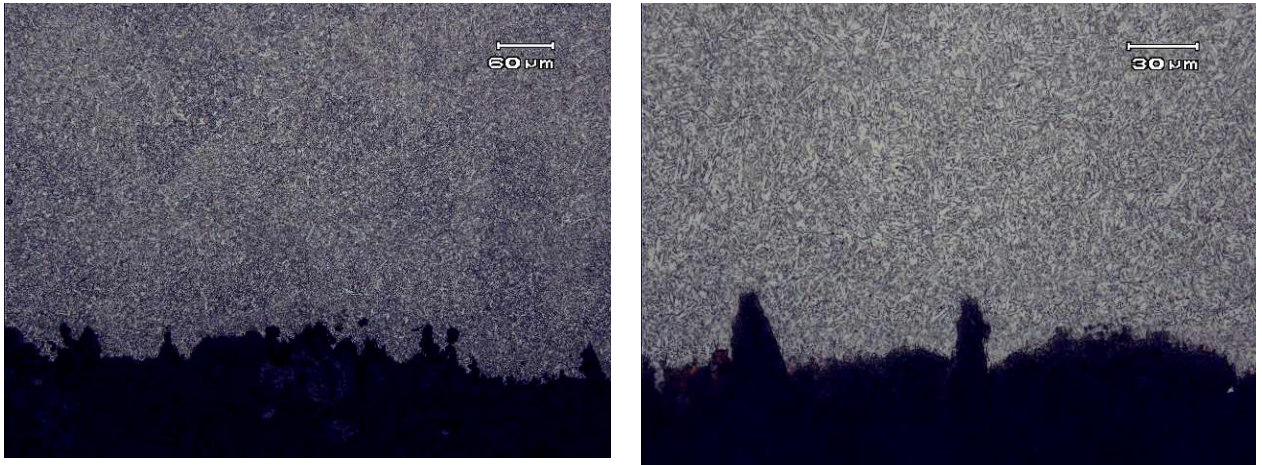
Figura A.12 – Metalografia amostra CP2-2, região 1, em maior magnificação mostrando propagação de trinca pela ZTA.
