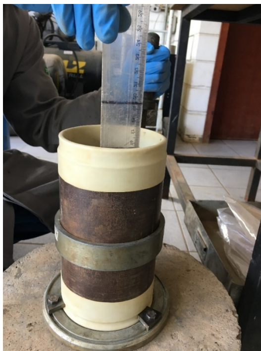
Figura 10 - Moldagem em camadas
