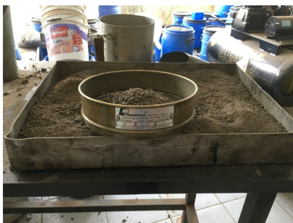
Figura 9 - Passagem pela peneira número 4 indicada pela norma
