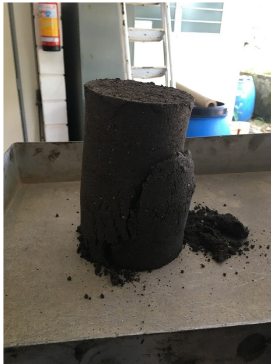
Figura 17 – Corpo de prova rompido
