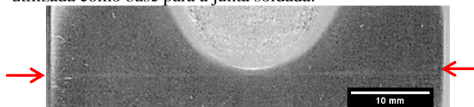
Figura 6.2 - Zona de segregação de impurezas da chapa utilizada como base para a junta soldada.
