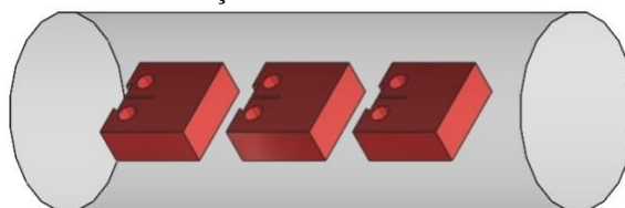
Figura 4.18 - Posicionamento dos corpos de prova no material do pino. Direção da trinca paralela ao sentido de laminação da barra.
