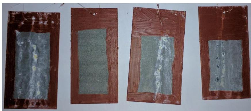
Figura 20 - Amostras 144 h de ensaio de névoa salina. Da esquerda para a direita, amostras F\_8 FCr\_8, FTan\_8 e F/T8.
