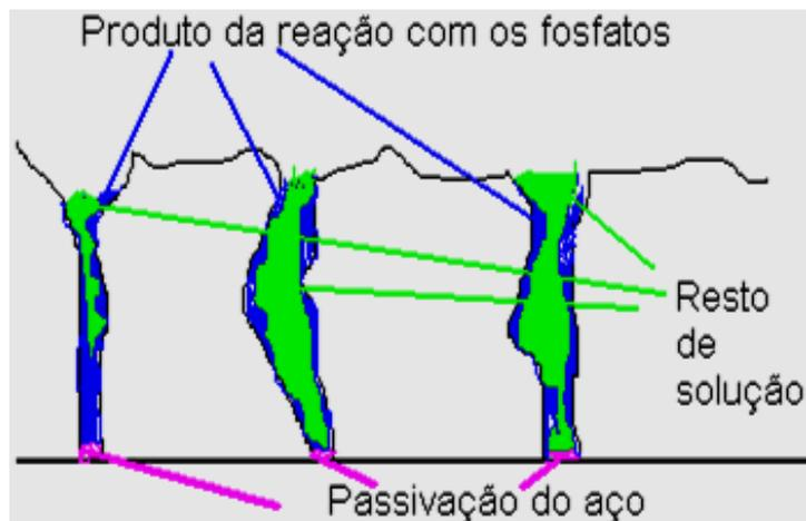
Figura 6 – Solução de cromatizante passivando o substrato e “tampando” os poros.
