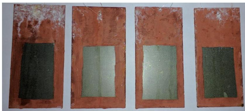
Figura 19 – Amostras 816 h de ensaio de névoa salina. Da esquerda para a direita, amostras F\_2, FCr3\_2, FTan\_2 e F/T\_2.
