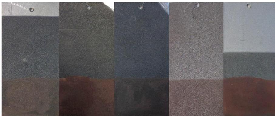
Figura 17 – Amostras após mergulho em solução de  $\text{CuSO}_4$ , da esquerda para a direita, amostras F, FCr3, FTan, F/T e FCR6.
