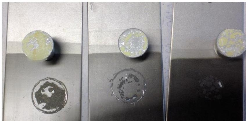
Figura 26 - Corpos de prova após o ensaio de pull-off das amostras FCr6\_7, FCr6\_8 e FCr6\_9.
