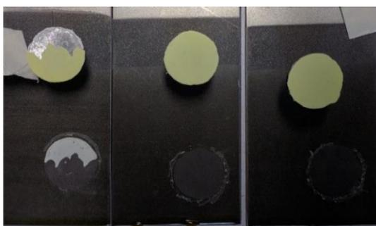
Figura 22 - Corpos de prova após o ensaio de pull-off das amostras F\_3, F\_2 e F\_1, respectivamente.
