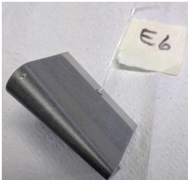
*Figura 21 – Corpo de prova utilizado no teste de flexão com mandril cônico, o qual é representa todas as outras amostras ensaiadas.*
