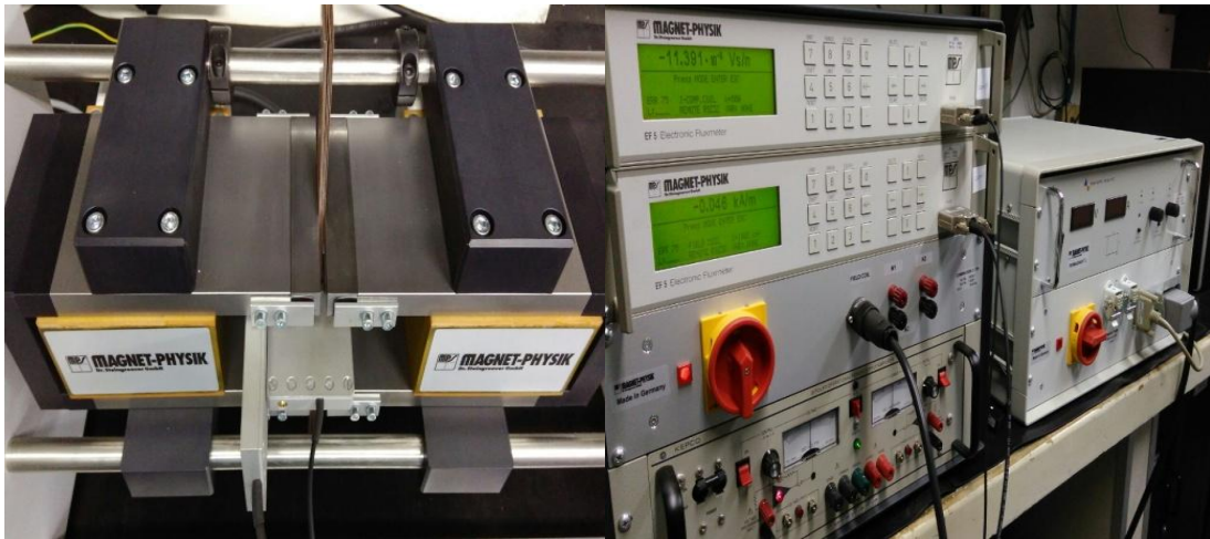
Figura 4 - Fotografias do processo de caracterização do pacote de chapas do núcleo ferromagnético no histeressímetro do LMEAE
