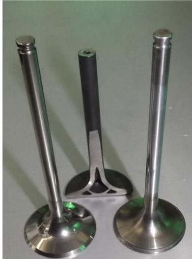
**Figura 12: Válvulas de admissão fabricadas com Inconel 718 sem revestimento na haste, antes e depois de teste em motor (24).**
