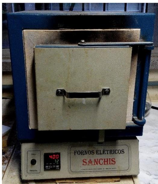
**Figura 42: Forno utilizado para realização dos tratamentos térmicos nas amostras de Ni-P.**
