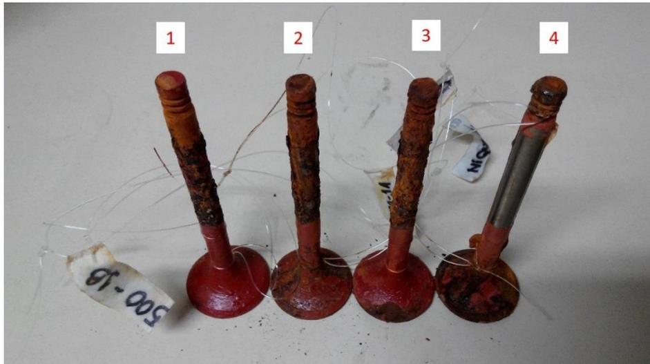
**Figura 80: Apresentação das amostras após teste de névoa salina: 1) EN 500-1 após atingir grau V5; 2) EN 400-1 após atingir grau V5; 3) Cromo, após atingir grau V5; 4) EN S/T°T° após 123 dias.**
