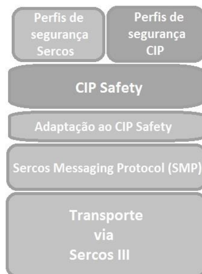
Figura 5 – Modelo estrutural do perfil de comunicação CIP Safety on Sercos
