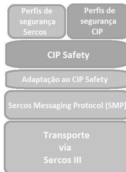
Figura 3.4 – Modelo estrutural do perfil de comunicação CIP Safety on Sercos
