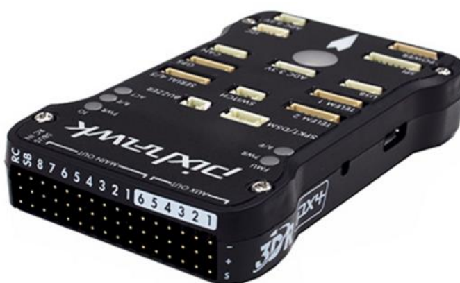
Figura 10 - Hardware do sistema PixHawk , fabricado pela empresa americana 3DR.
