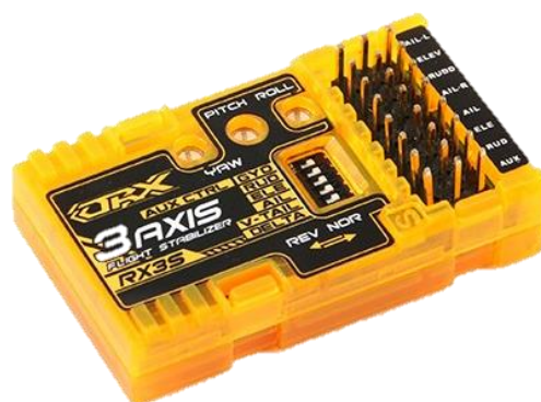
Figura 8 - Sistema de estabilização RX35.
