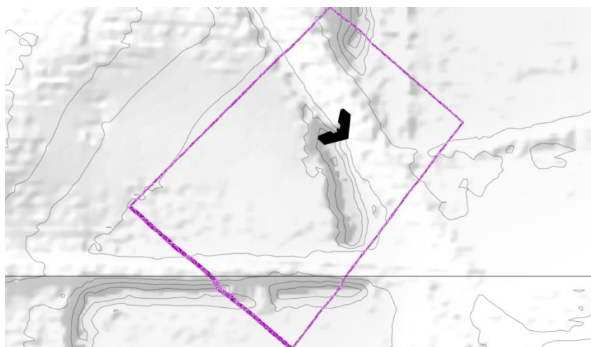
Figura 41 - A linha representa o footprint , em solo, da fotografia tirada pelo VANT.
