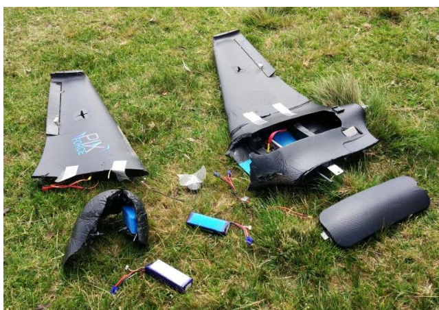
Figura 9 - Avião após queda causada por falha no sistema de GPS.
