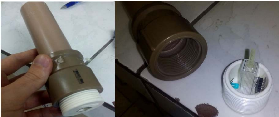
Figura 8: Sensor utilizado no cultivo contínuo (Protótipo 3).
