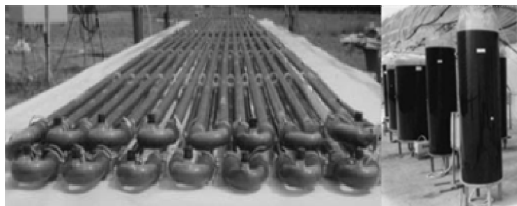
Figura 3: FBRs tubular (esquerda) e em coluna (direita) (Adaptado de: RICHMOND, 2008).
