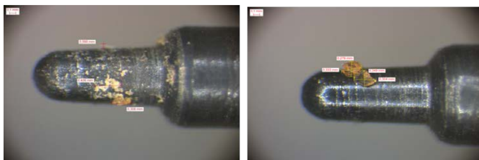
Figura 20 – Vista do parafuso H dos carburadores 19 sem aditivo (a) e 17 com aditivo (b)
