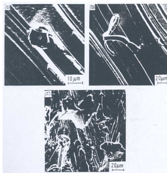
Figura 5 - Micrografias da superfície dos sólidos que sofreram desgaste abrasivo: (a) microsulcamento, (b) microcorte, (c) microlascamento. Fonte: Gahr, 1987.
