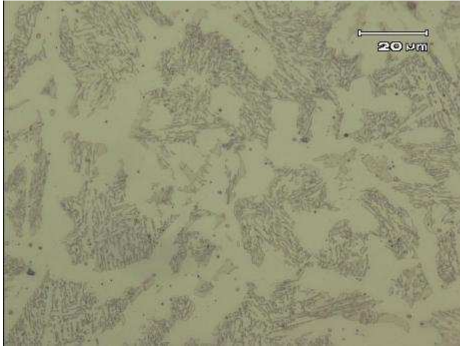
Figura 30 – Micrografia revestimento sem elementos de liga (CP 7), aumento 1000x
