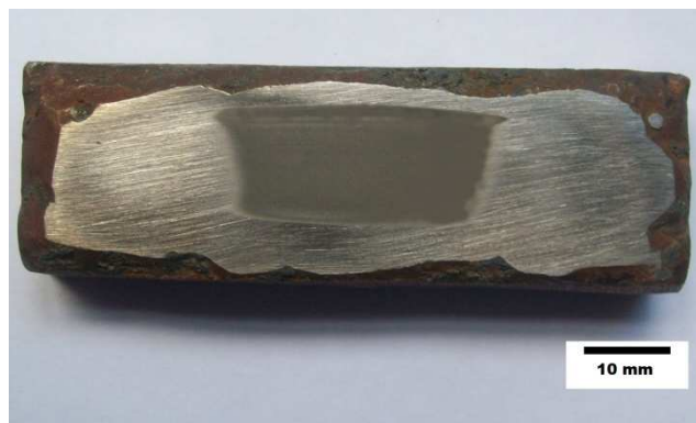
Figura 22 – Corpo de prova após o ensaio de desgaste abrasivo.
