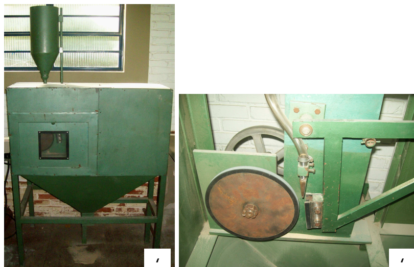
Figura 21 – (a) Equipamento de ensaio de desgaste abrasivo (b) detalhe disco e bocal.
