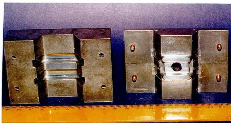
Figura 5.3: Molde da sapata-tensora, em Zamak.
