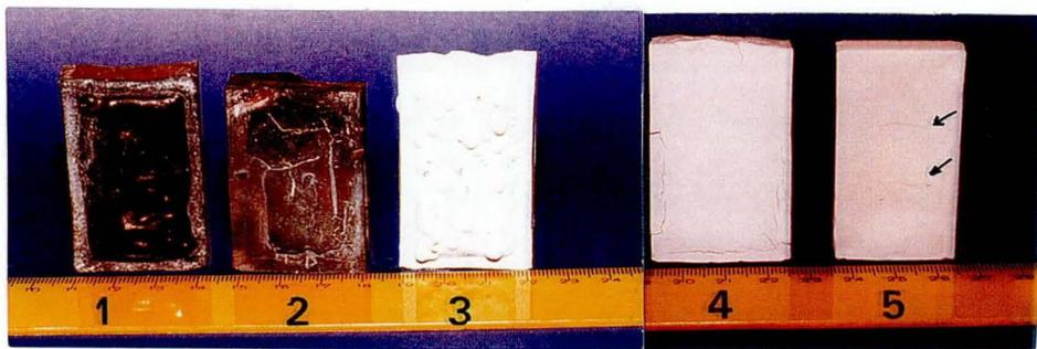
Figura 5.25: Resultados obtidos da extração de ligantes de peças espessas de alumina A1000SG na câmara de vácuo. A peça (1) ficou com a superfície exposta ao ar, sem vácuo; a peça (2) ficou totalmente encoberta por pó, sem vácuo; a peça (3) ficou com a superfície apoiada contra o filme de PTFE, sem vácuo; a peça (4) é a (3) vista por baixo; na peça (5), a extração dos ligantes foi feita sob vácuo (peça já sinterizada).
