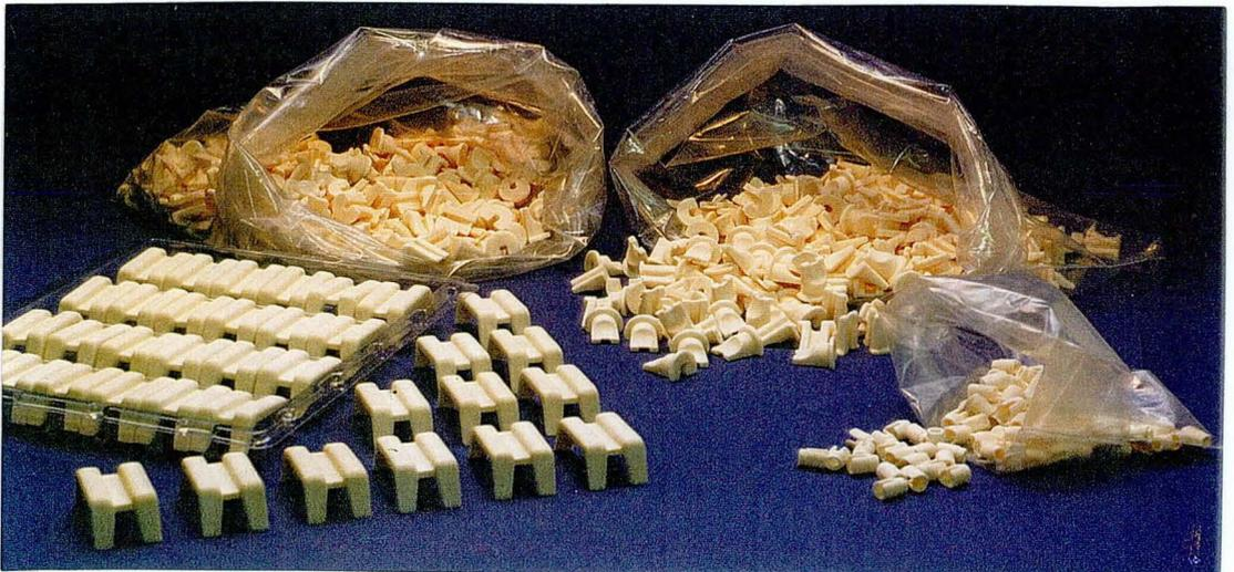
Figura 5.5: Guia-fios e sapatas-tensoras produzidas na injetora MIGL-33 em grande quantidade.
