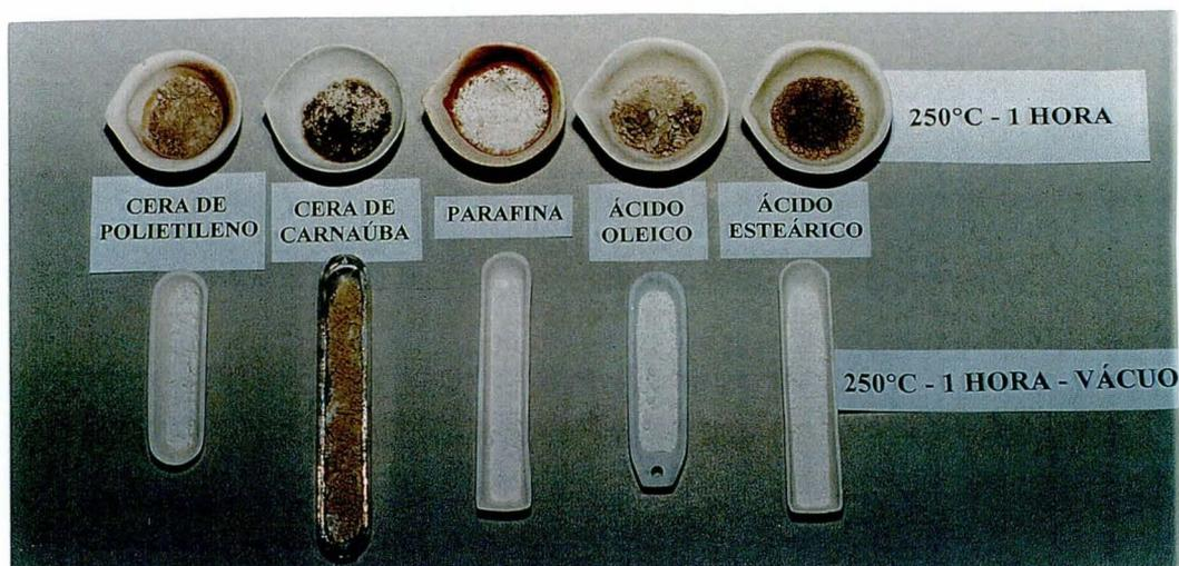
Figura 5.41: Mistura de ligantes e alumina, queimadas ao ar e em vácuo, a 250°C, por 1 hora. Em alguns casos, a quantidade de ligante adicionada ao pó de alumina foi maior do que o usual, devido à dificuldade de se efetuar uma boa mistura.
