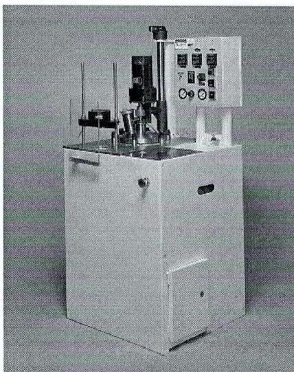
Figura 4.1: *Injetora MIGL-33 da Peltsman (0,64 x 0,61 x 1,43 m).*
