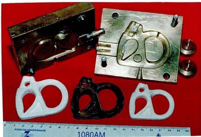
Figura 5.2: Guia-fio complexo, em diferentes estágios de produção, e o respectivo molde em latão empregado para sua injeção.
