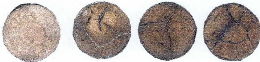
Figura 5.30: Peças de alumina com ligantes, queimadas a  $250^{\circ}\text{C}$ , ao ar. A 1<sup>a</sup> da esquerda não possui carnaúba, e as outras possuem quantidades crescentes de carnaúba (da esquerda para a direita). O diâmetro destas peças é de 26 mm e sua altura, 15 mm.
