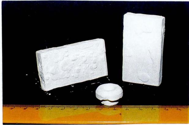
Figura 5.20: Peças obtidas por moldagem por injeção e extração dos ligantes, em leito de pó, em 3 dias até 250° C e após queimadas a 500° C.
