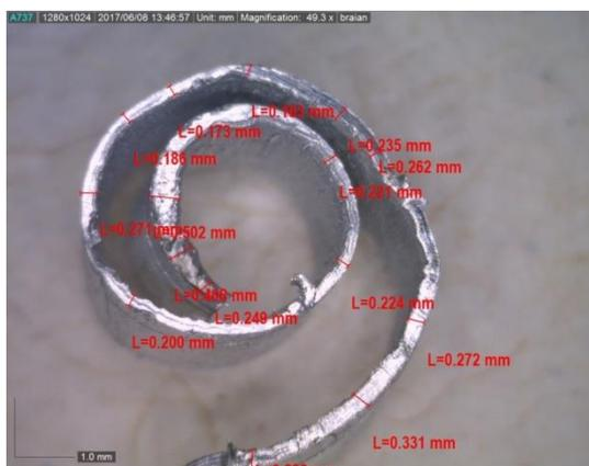
Figura 0.2 Método de medidas das espessuras dos cavacos do AISI 6262.
