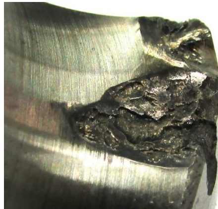
Figura 4.1 – Amostra 1, pistas 1, amostra com queima de retífica.
