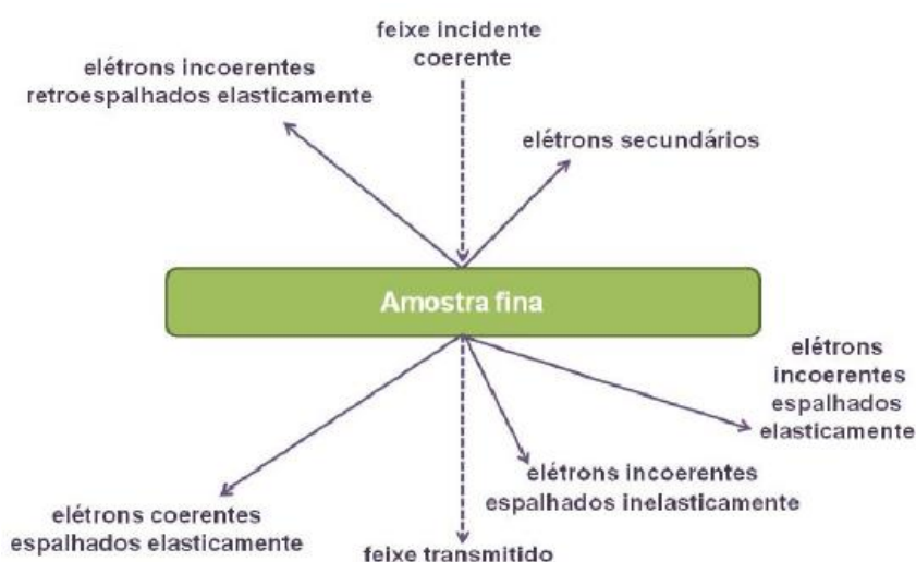
Figura 3.10: Processos de espalhamento sofridos por elétrons ao interagir com a amostra.
