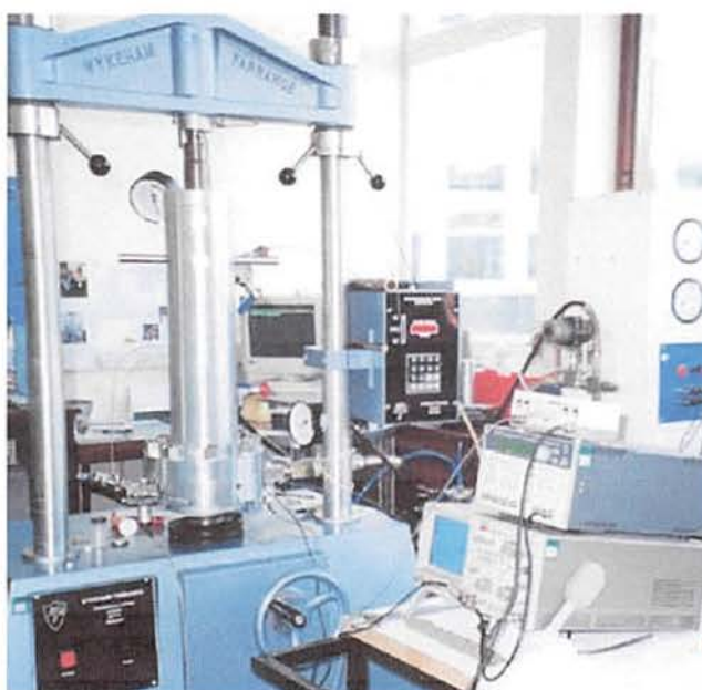
Figura 3.7: Visão geral do equipamento triaxial utilizado nos ensaios de compressão isotrópica
