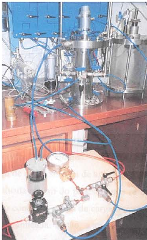
Figura 3.3: Detalhe do equipamento triaxial e aplicação de vácuo durante a moldagem do corpo de prova
