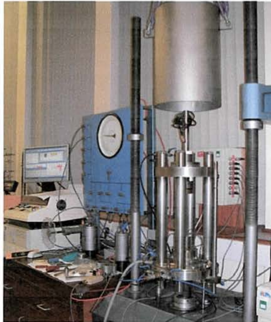
Figura 3.5: Visão geral do equipamento triaxial utilizado nos ensaios de compressão triaxial até 7000kPa.
