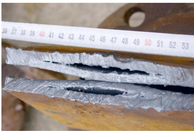
Figura 2. Defeitos de laminação em componente metálico. (GOMERA et al., 2010)
