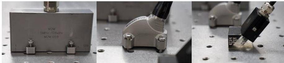
Figura 8. Sensores matriciais de *Phased Array* contendo 128, 64 e 16 elementos, respectivamente.
