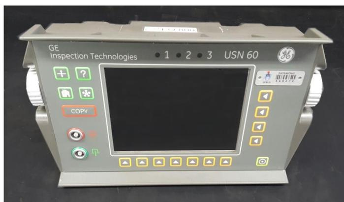
Figura 15. Equipamento de ultrassom utilizado para estimar a atenuação pela distância percorrida.
