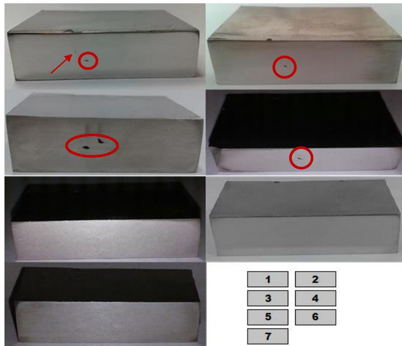
Figura 45. Cortes transversais realizados nas mesmas posições em que o TFM foi aplicado para esse bloco.
