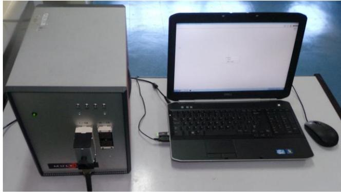
Figura 16. Equipamento de *Phased Array* utilizado para aquisição de dados, conectado ao computador via cabo USB.
