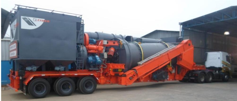
Figura 3.1 Usina de asfalto tipo móvel
