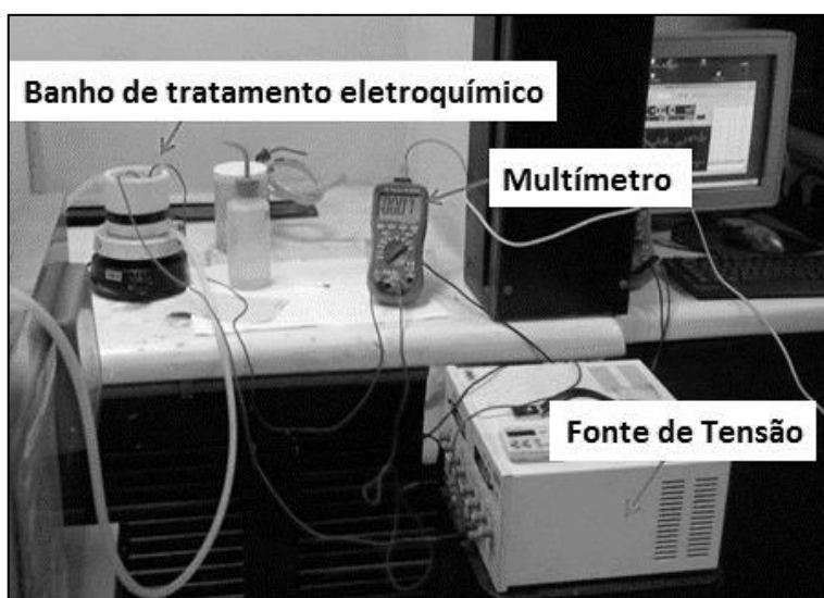
Figura 15: Foto do sistema de tratamento eletroquímico utilizado nesse estudo.
