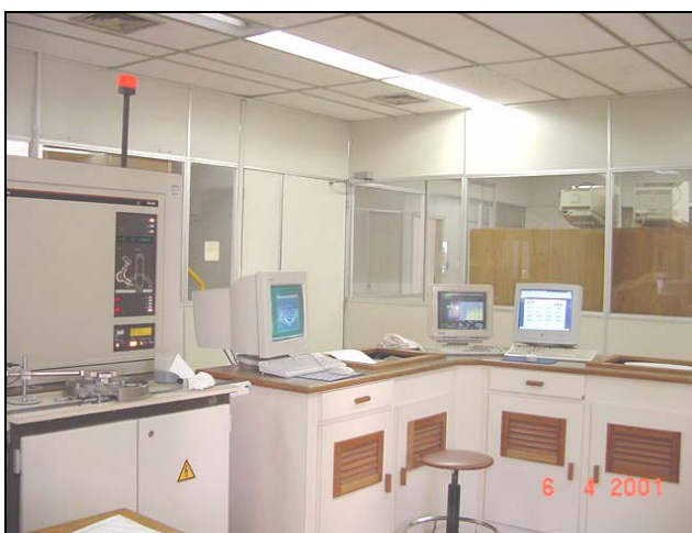
Figura C.15 – Sala de controle da qualidade do cimento: à esquerda fluorescência de raio-x.
