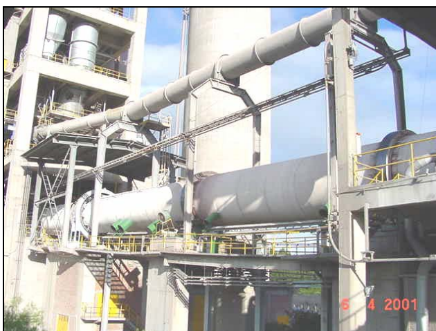
Figura C.14 – Forno Kiln: fabricação do clínquer.
