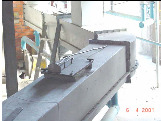
Figura 29 – Ponto de coleta de amostras: tubulação de saída do moinho (corrente G1).
