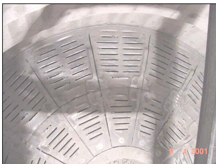
Figura 20 – Grelha intermediária (k1/k2) do moinho de bolas: vista interna da câmara 1.
