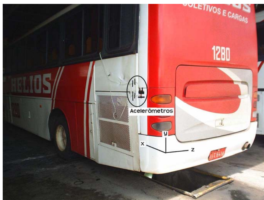
Figura 6.58 – Local de fixação dos microacelerômetros
