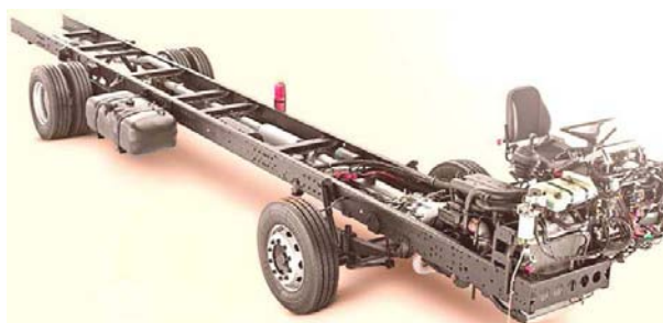
Figura 4.13 – Chassi de motor dianteiro (Fonte: Diretrizes para construção de carrocerias – Mercedes-Benz)
