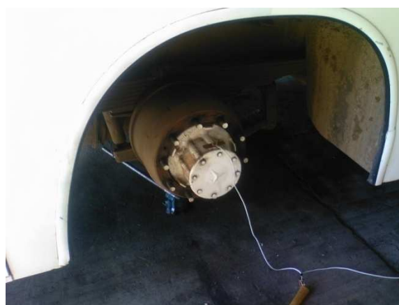
b) Acelerômetro no rodado traseiro
