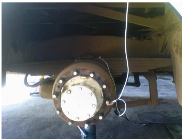
Figura 5.40 – Acelerômetro montado no feixe de molas
