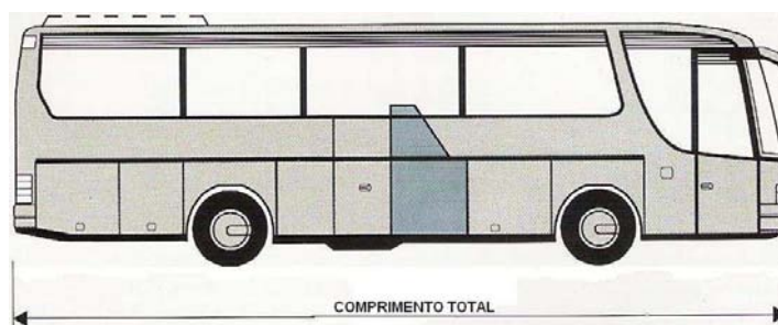
Figura 4.3 – Comprimento máximo para carroceria de ônibus
