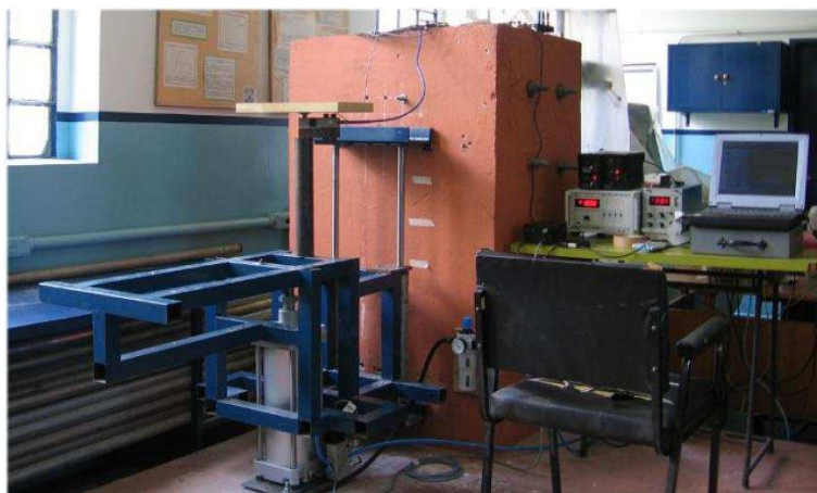
Figura 2.18 – Mesa vibratória com sistema de aquisição de dados (Fonte: Becker, 2006)
