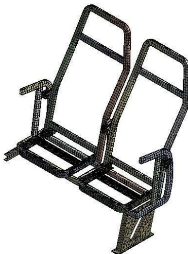
Figura 6.12 – Malha de elementos finitos estrutura poltrona
