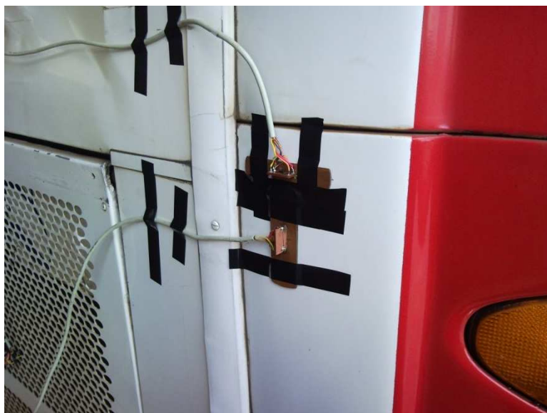
Figura 6.59 – Acelerômetros fixados na carroceria
