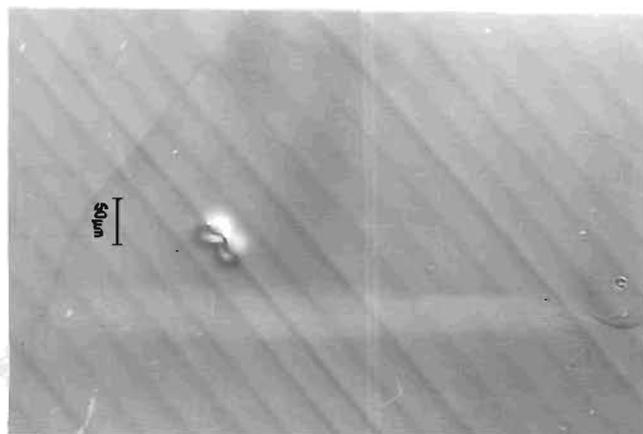
**Fig.III-20-** Fotomicrografia de estrias rotacionais e “pits” relacionados com discordâncias tipo “grown-in”, para o plano (110) em uma lâmina de GaSb dopado Al. Atacada durante 2 min com  $D_{1/4} S_{1/5}$ .
