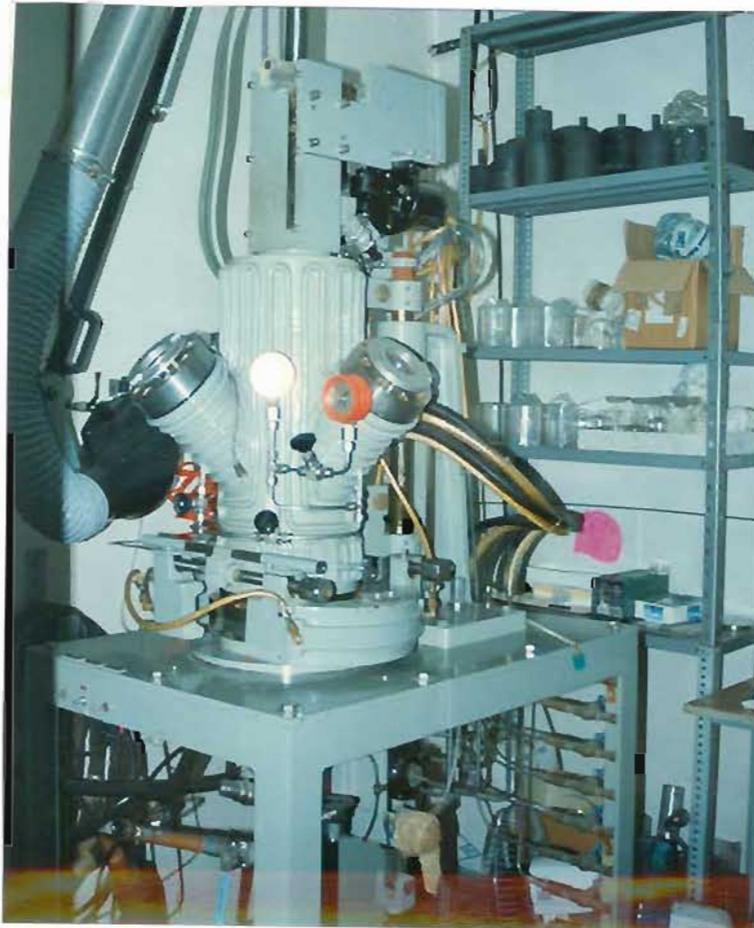
**Fig. II-3- Forno C:** A foto mostra parte do sistema- Cz para crescimento de cristais semicondutores até 15 atm de pressão, o aquecimento é feito por RF. Observa-se a câmara de aço com dois visores laterais. Na parte superior o sistema de puxamento controle de peso do cristal e temperatura. Na parte inferior observa-se o sistema de válvulas para o controle da pressão, vácuo e refrigeração do sistema.
