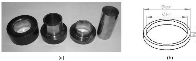
Figura 22 - (a) matriz para compactação e (b) geometria da amostra.
