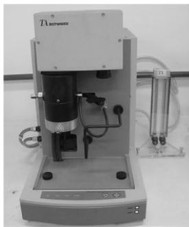
Figura 28 - Equipamento de termogravimetria do LaPol.
