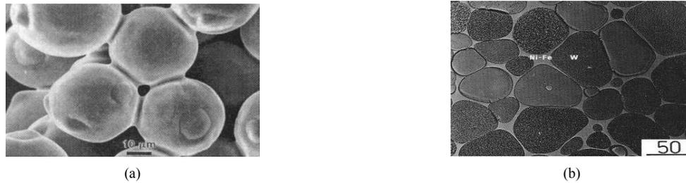
Figura 12 - (a) sinterização por fase sólida, (b) sinterização por fase líquida [16].
