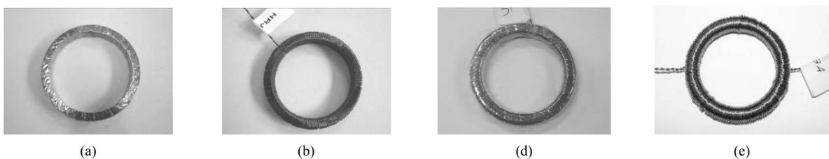
Figura 32 - Etapas de preparação das amostras: (a) isolamento, (b) enrolamento secundário, (c) isolamento e (d) enrolamento do primário.
