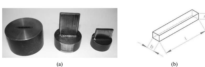
Figura 23 - (a) matriz para compactação e (b) geometria da amostra.
