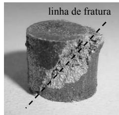
Figura 44 - Amostra resinada após ensaio de compressão identificando o comportamento da fratura.
