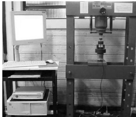
Figura 24 - Prensa utilizada para compactar as amostras e sistema para aquisição de dados.
