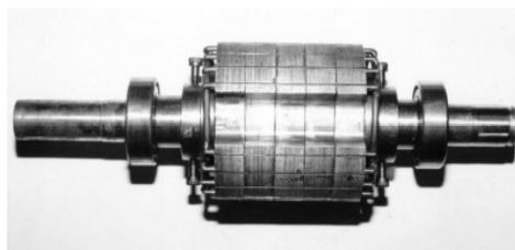
Figura 16 - Rotor de liga Fe-50Ni sinterizado.
