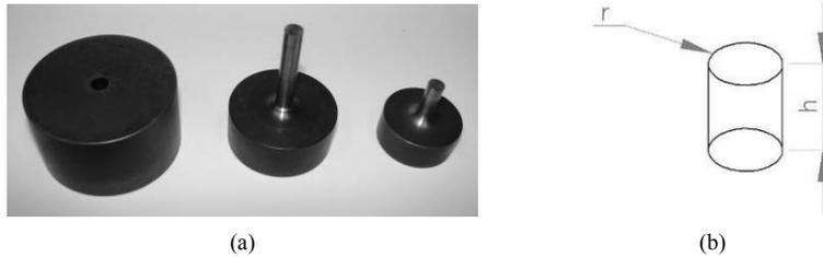
Figura 21 - (a) matriz para compactação e (b) geometria da amostra.
