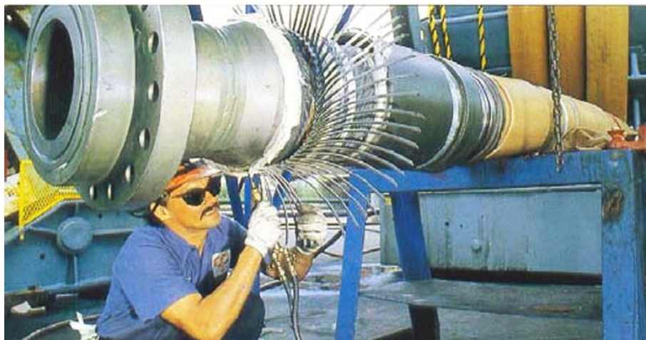
Figura 3: Montagem em campo do sistema de conexão de um Riser Flexível 11 .
