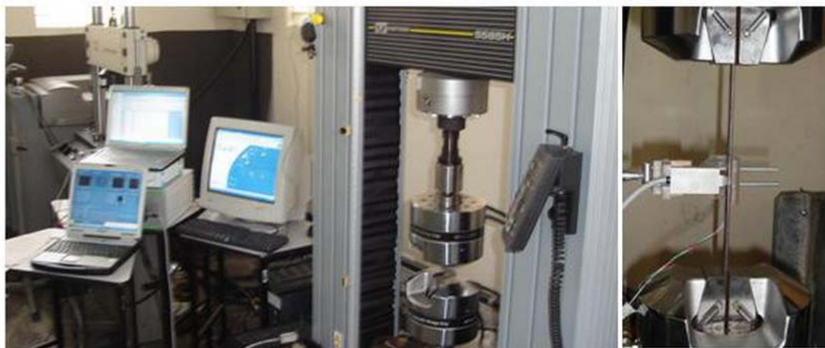
Figura 29: Configuração dos equipamentos utilizados durante os ensaios de tração das tiras da armadura de tração de Risers flexíveis de 6”.
