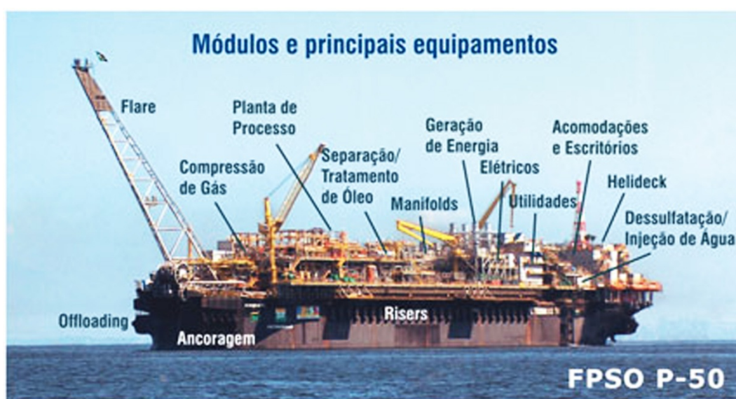
Figura 5: Plataforma P-50 – Unidade de Produção e Estocagem (FPSOs – “Floating Production Storage and Offloading”) 12 .
