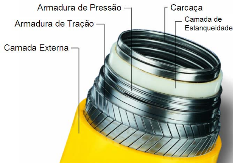
Figura 2: Configuração típica de um duto flexível do tipo Unbonded 10 .
