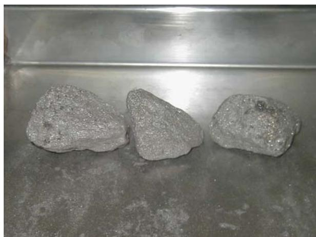
**Figura 3.3:** Liga Fe-Cr-AC comercial utilizada nos experimentos de lixiviação
