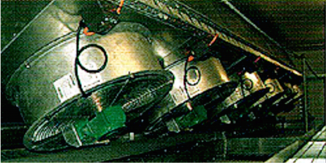
Figura 3 Resfriadores de corrente de ar da empresa Stork Bronswerk.
