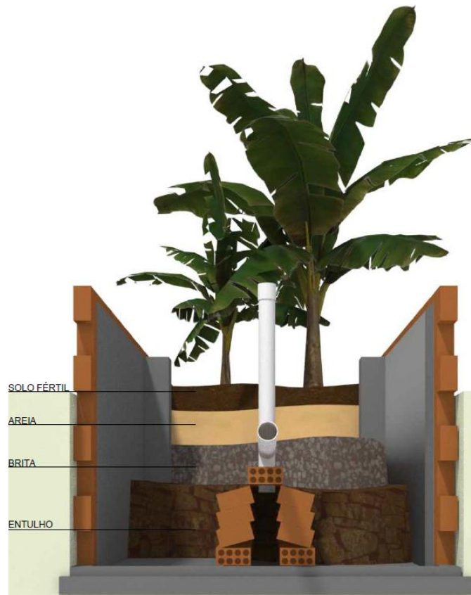
Figura 14 – Tanque bioséptico, com canteiro de bananeiras
