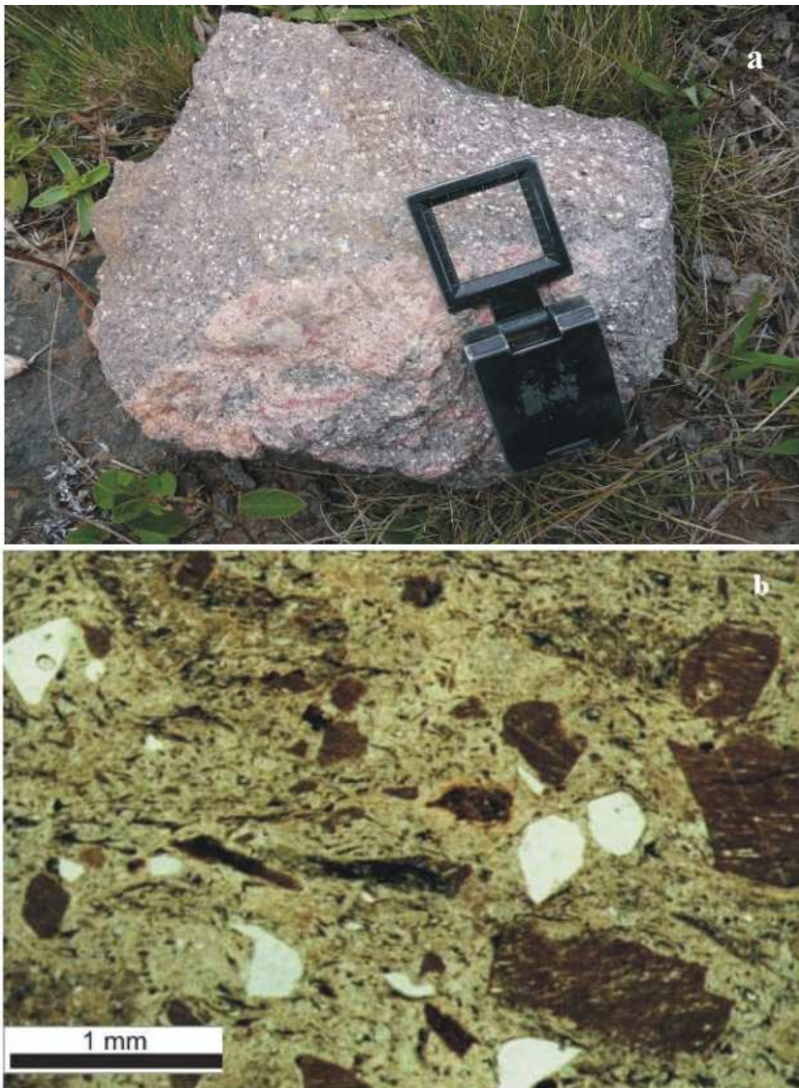
Figura 8 – Características típicas dos ignimbritos com alto grau de soldagem do Cerro Chato: a) feições macroscópicas – rico em cristais de quartzo e K-feldspato, raros litoclastos e incipiente textura eutaxítica; b) feições microscópicas (LN – 25x) apresentando as mesmas características observadas em microscopia.
