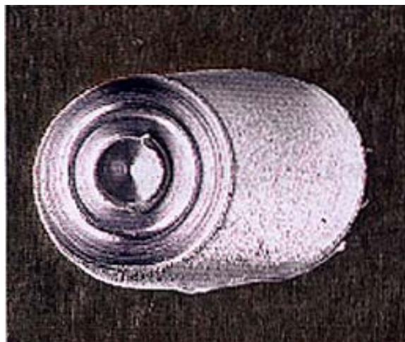
Figura 6- Aspecto da SPFMM após a remoção do pino em um processo com translação da ferramenta.
