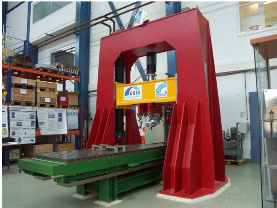
Figura 22- Pórtico de soldagem.
