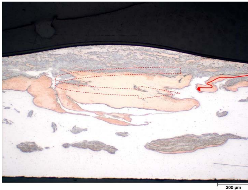
Figura 89- Detalhe mostrando o fluxo de material na região abaixo do pino da ferramenta, onde se observa grande concentração de cobre não misturado ao alumínio. Ferramenta F9.
