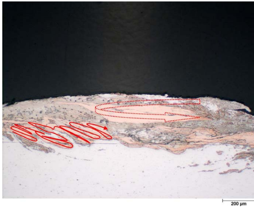
Figura 100- Imagem mostrando a região abaixo do pino onde se observa uma maior quantidade de cobre. Ferramenta F12.
