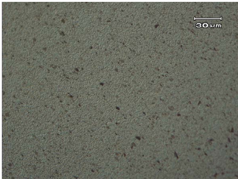
Figura 77- Micrografia da zona de mistura (ZM). Nesta figura se observa os grãos recristalizados e as partículas de segunda fase quebradas e de menor tamanho, sem orientação preferencial. Amostra F4-2000 RPM.
