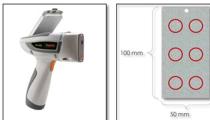
Figura 5: Niton XL3t e croqui dos pontos analisados em cada chapa revestida.
