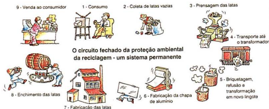
Fig. n° 13 Ciclo das Latas de Alumínio - A Figura mostra o ciclo de produção e reciclagem de latas de alumínio
