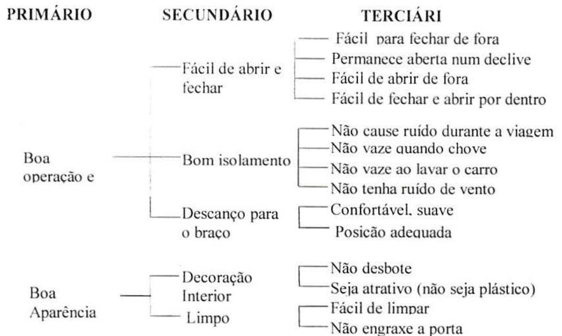
Figura 3.1 - Árvore lógica dos itens da qualidade demandada para a “porta de um automóvel”. Fonte: Hauser e Clausing, 1988, p. 65.
