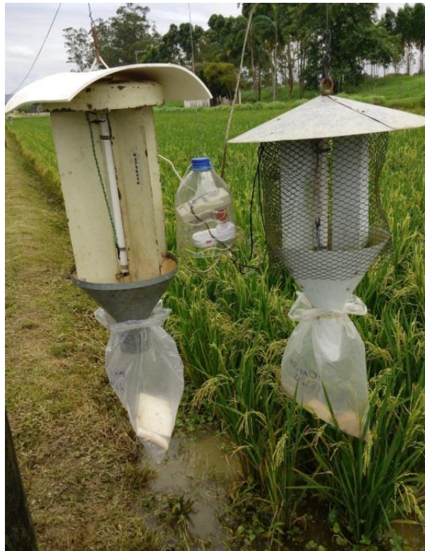
Figura 8. Armadilhas luminosas do tipo “Luiz de Queiroz”, instaladas ao lado da taipa de arroz, conectadas com timers e sacos plásticos instalados para coleta dos insetos.
