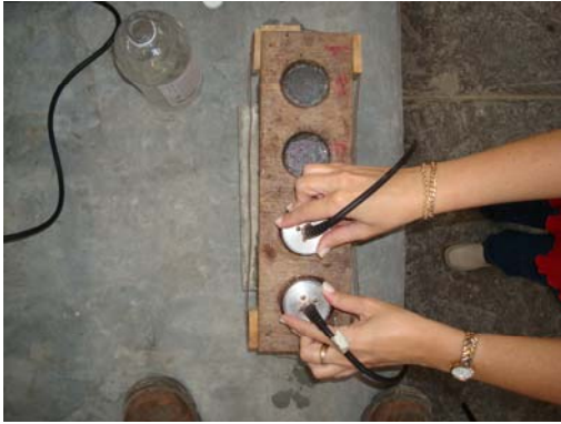
Figura 33: ensaio de ultra-som pelo método indireto com 3 pontos a) realização do ensaio; b) leitura do tempo
