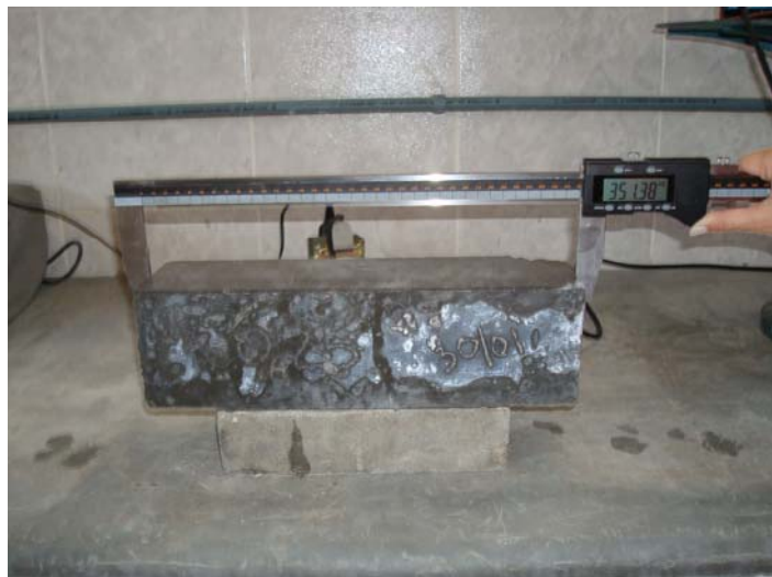
Figura 35: medição do corpo-de-prova com paquímetro
