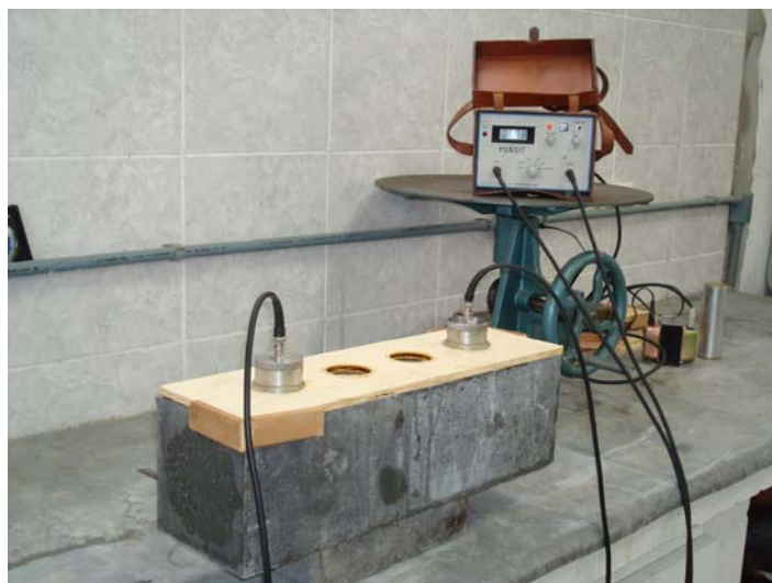
Figura 14: execução do ensaio de ultra-som pelo método indireto
