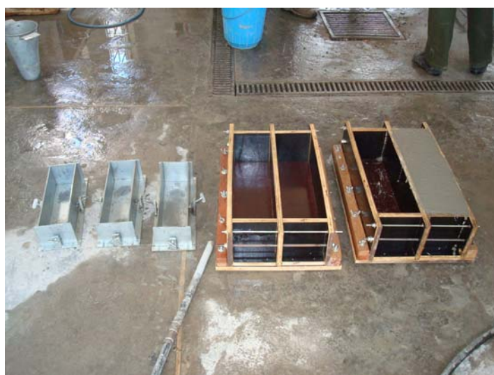
Figura 4: fôrmas prismáticas utilizadas nos ensaios
