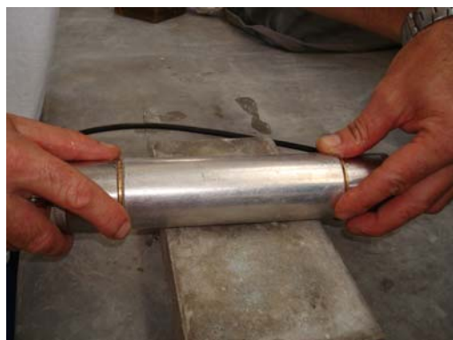
Figura 31: realização da aferição do ultra-som a) aferição do equipamento; b) leitura do tempo
