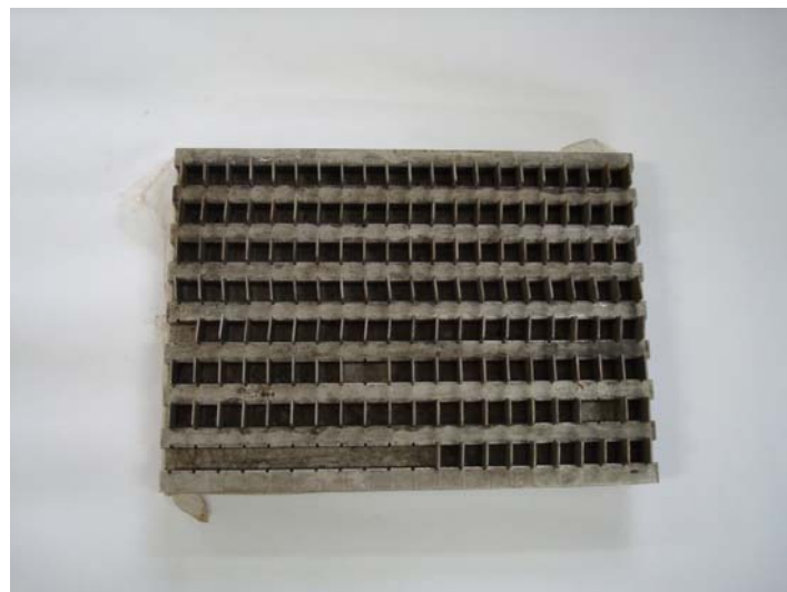
Figura 24: fôrma para pasta, 12,5x12,5x12,5mm
