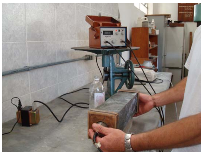
Figura 32: ensaio de ultra-som pelo método direto
