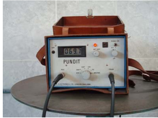
Figura 33: ensaio de ultra-som pelo método indireto com 3 pontos a) realização do ensaio; b) leitura do tempo
