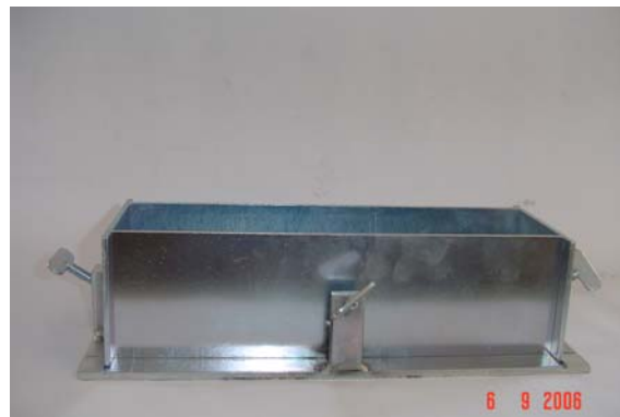
Figura 23: fôrma para concreto, 100x100x350mm, utilizada no ensaio
