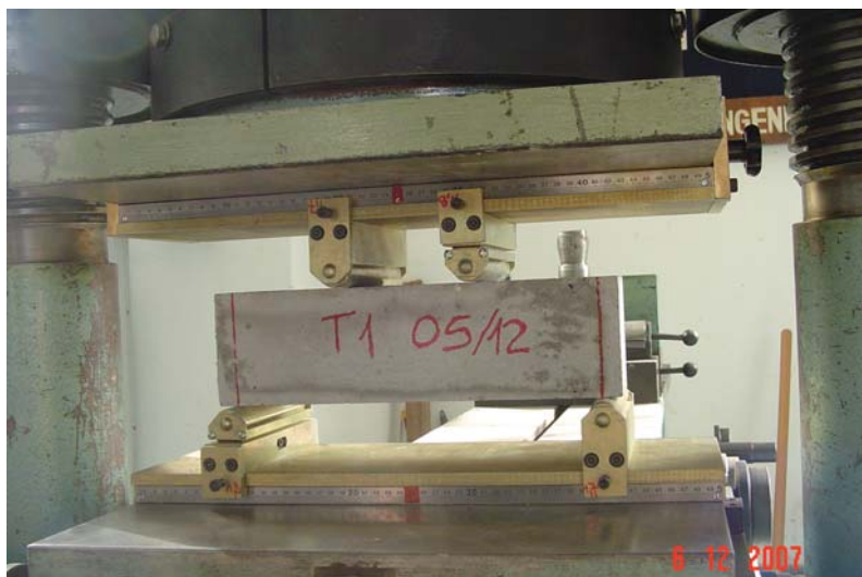
Figura 13: dispositivo empregado para execução do ensaio de resistência à tração na flexão
