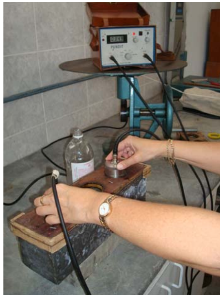
Figura 34: ensaio de ultra-som pelo método indireto com 2 pontos
