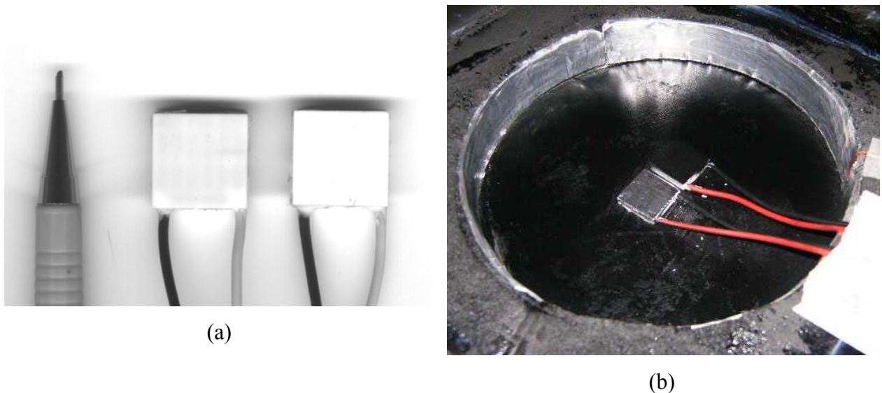
Figura 6.11. Sensores térmicos radiométricos tipo termopilha (a) pastilhas Peltier sem revestimento, (b) pastilhas Peltier, um recoberto com alumínio, outro recoberto com tinta preta, montados internamente ao calorímetro colados sobre a superfície 1 (superfície quente emissora)
