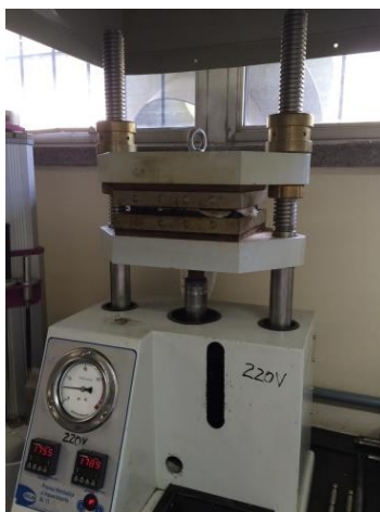
Figura 10: Processo de expansão da espuma TPS na prensa térmica.
