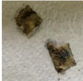
Figura 32: Material remanescente da espuma TPS de batata com recobrimento de 6% m/v PLA.
