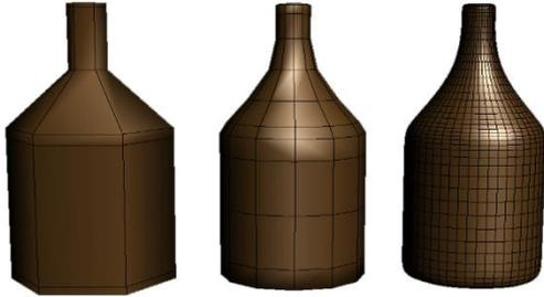
Figura 06: Três objetos modelados no 3ds Max 2011: uma garrafa low-poly com 38 polígonos à esquerda, uma poligonagem média, ao centro, com 312 polígonos e outra high poly, com 4992 polígonos, à direita.
