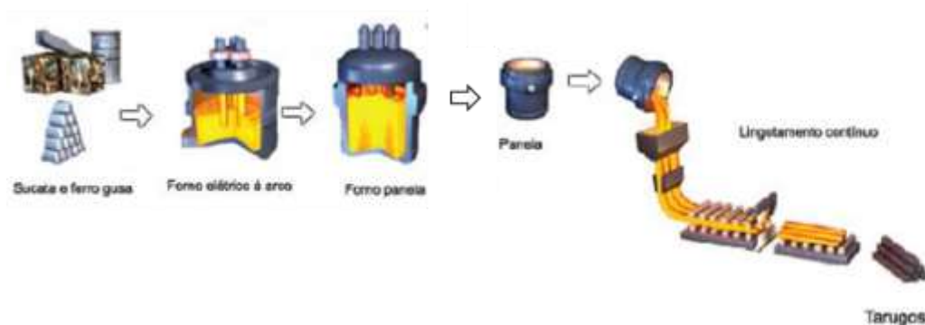
Figura 2.1: Desenho esquemático das etapas de processo de aços longos comuns (5).
