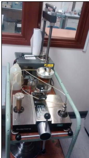
Figura 76-Equipamento utilizado para calibrar os transdutores de pressão.
