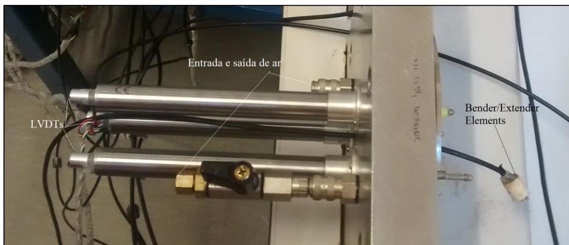
Figura 71-Parede utilizada para selar a almofada de ar com detalhes da instrumentação do equipamento.
