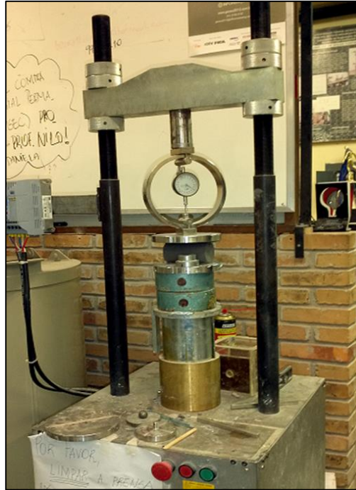
Figura 65-Ensaio de Tração na Compressão Diametral.
