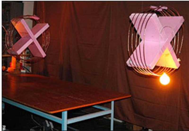
Fig. 2.5: Experiência de WPT do MIT, em 2007, utilizando acoplamento ressonante para transmitir 60W de potência a uma lâmpada distante 2m do transmissor [6].
