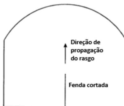
Figura 49: Formato do corpo de prova utilizado na análise de resistência ao rasgo Elmendorf
