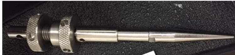
Figura 51: Ponteira utilizada na análise de perfuração
