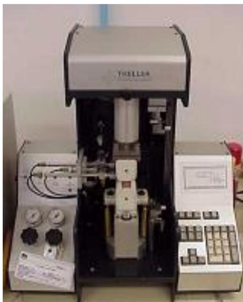
Figura 47: Equipamento EB Laboratory Heat Sealer da Theller
