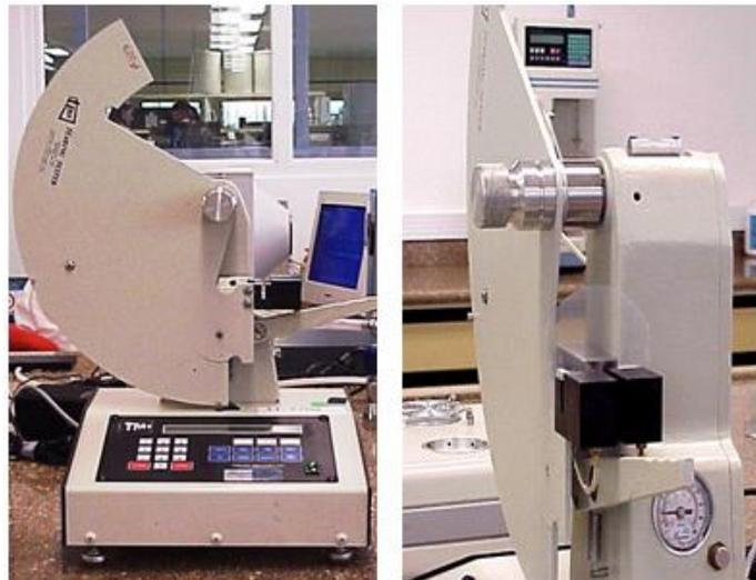
Figura 48: Equipamento Tearing Tester 83-11-00 da TMI
