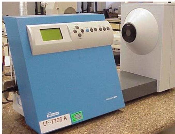
Figura 58: Opacímetro Haze-Garde Plus da BYK-Gardner
