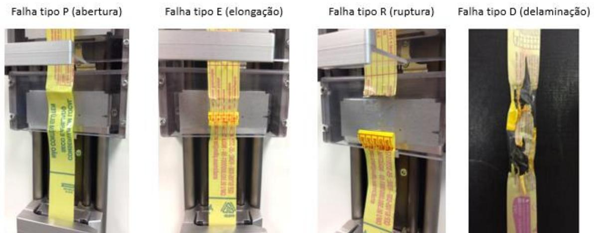
Figura 46: Tipos de falha na análise de *Hot Tack*
