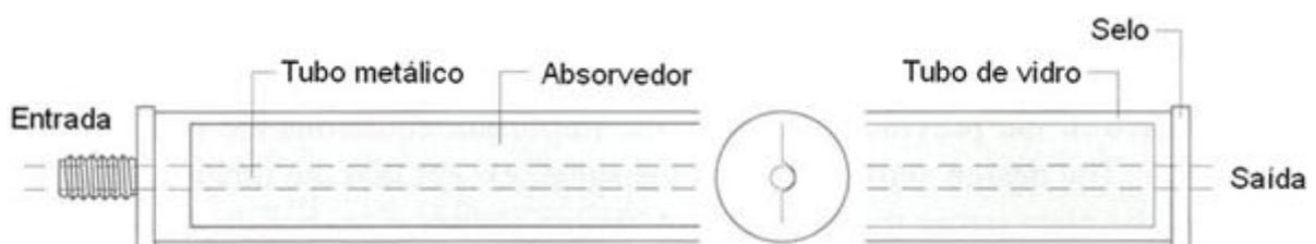
Figura 3.1 – Modelos de coletores de tubos de vidro evacuado.
