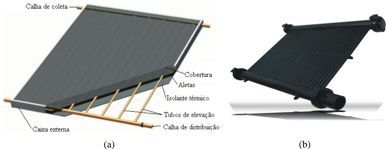
Figura 2.3 – Tipos de coletores solares planos: (a) com cobertura. Fonte: modificado de (solares-online.com.br). (b) sem cobertura. Fonte: aquecimentocomcoletorsolar.com.br
