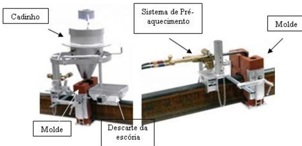
Figura 2.12 – Equipamentos utilizados na soldagem aluminotérmica. (KLK)
