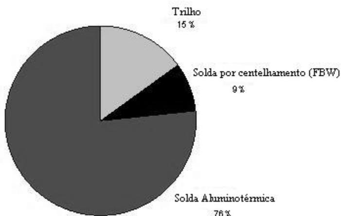
Figura 2.26 – Distribuição dos locais de falha em uma ferrovia de carga pesada (DUVEL, 2005).
