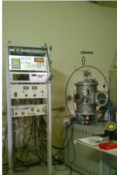
Figura 4.2.1: Imagem do Sputtering do laboratório de filmes finos e nanotecnologia no IF- UFRGS (L3FNANO).
