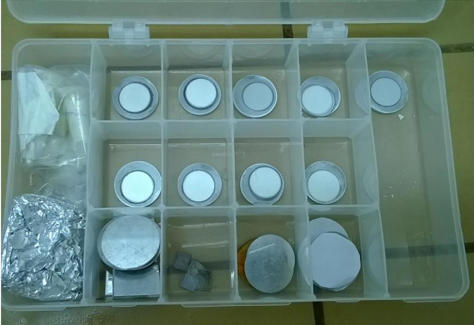
Figura 4.4.1: Imagem das amostras anodizadas no Laboratório de Filmes Finos e Nanotecnologia da UFRGS (L3FNANO).
