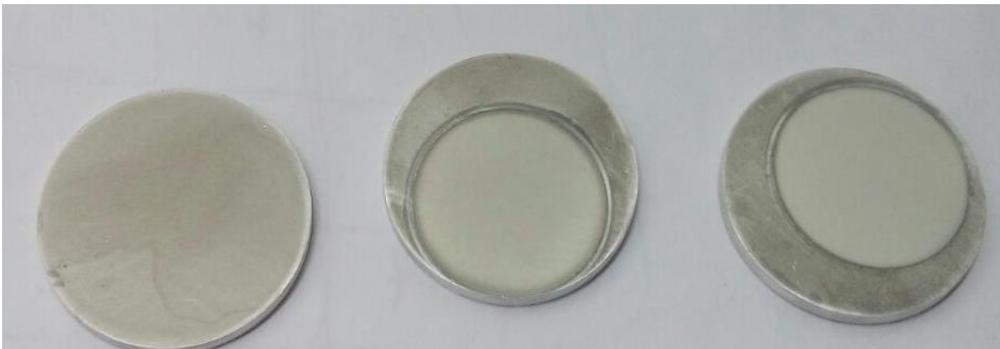
Figura 4.4.2: Imagem das amostras anodizadas. Da esquerda para direita, respectivamente: apenas eletropolida, primeira e segunda anodização.
