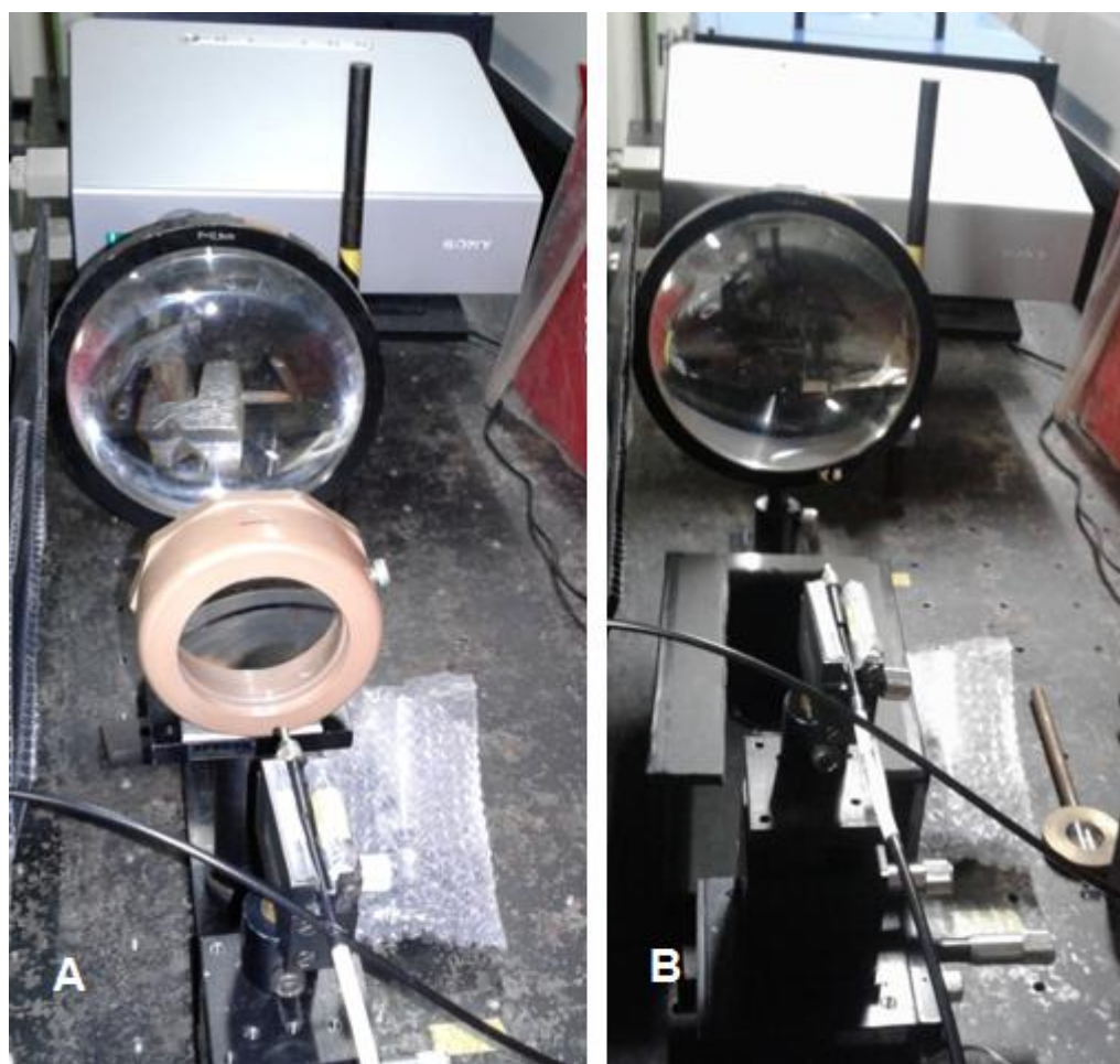
Figura 61 - Focalização da saída do projetor na fibra óptica. A) Arranjo de duas lentes em sequência na tentativa de melhorar a focalização e aumentar a potência do feixe de saída. B) Arranjo com uma única lente para focalizar a luz na fibra óptica.
