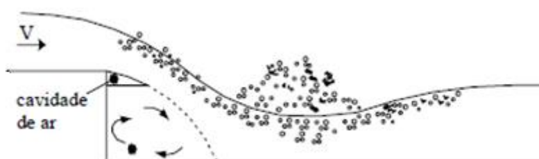
Figura 7: Esboço de um escoamento de transição (fonte: adaptado de Simões, 2008).
