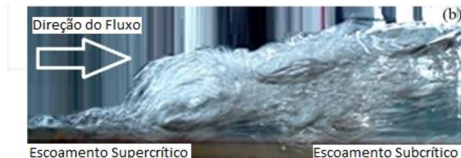
Figura 19: Ressonância hidráulica (fonte: Schulz et al. 2015)
