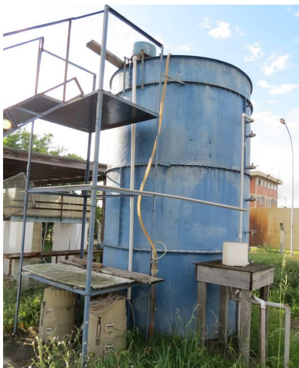
Figura 14. Reator UASB em escala piloto.
