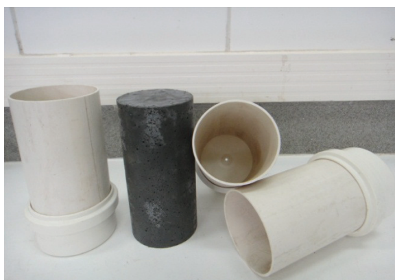
Figura 33– Detalhe das fôrmas em PVC confeccionadas para os ensaios de compressão nos corpos de prova dos traços de CPR.
