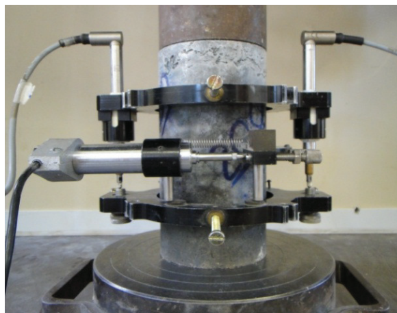
Figura 52– Execução do ensaio para determinação do módulo de elasticidade longitudinal e transversal à compressão utilizando um compressômetro de três anéis.
