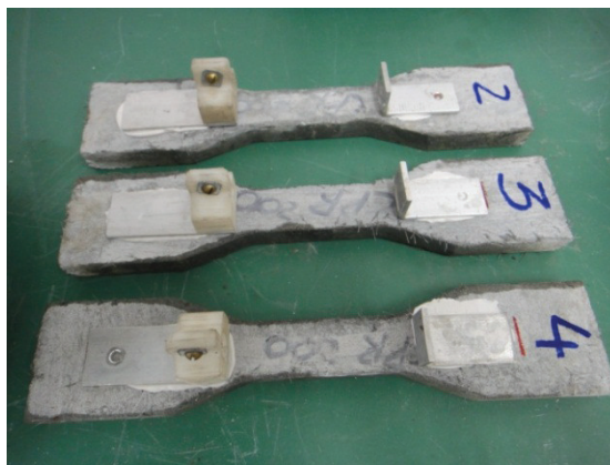
Figura 48– Corpos de prova utilizados no ensaio de tração direta dos traços de CPR.
