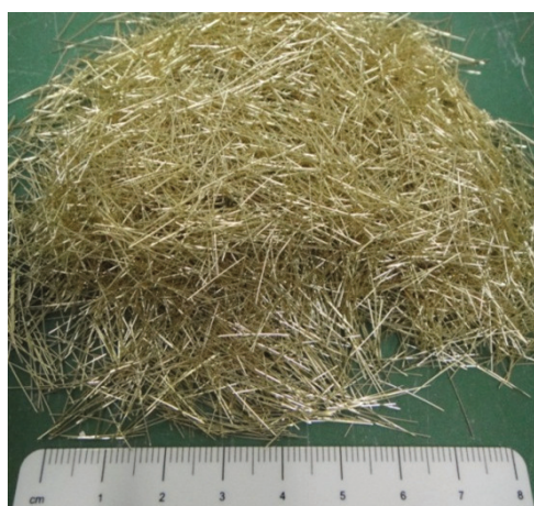
Figura 24 – Aspecto visual da fibra metálica utilizada nos traços CPR.
