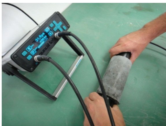
Figura 54– Detalhe da execução do ensaio de VPU em um corpo de prova.
