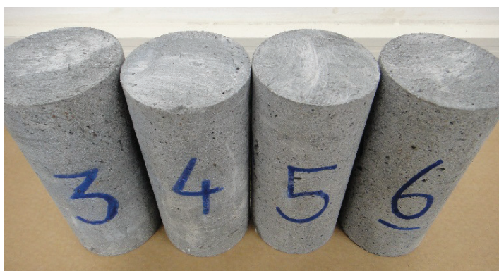
Figura 35– Aspecto dos corpos de prova extraídos dos prismas ensaiados à flexão.
