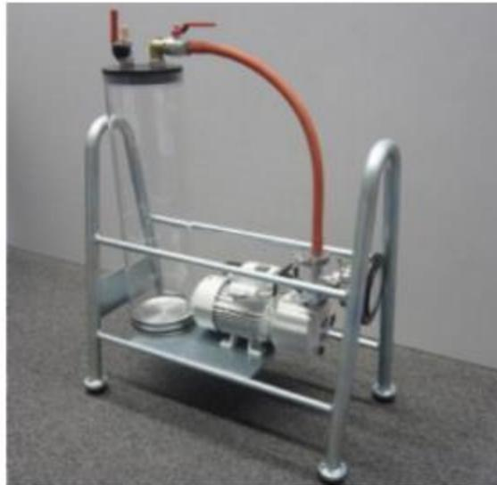
Figura 26 – Câmara de vácuo
