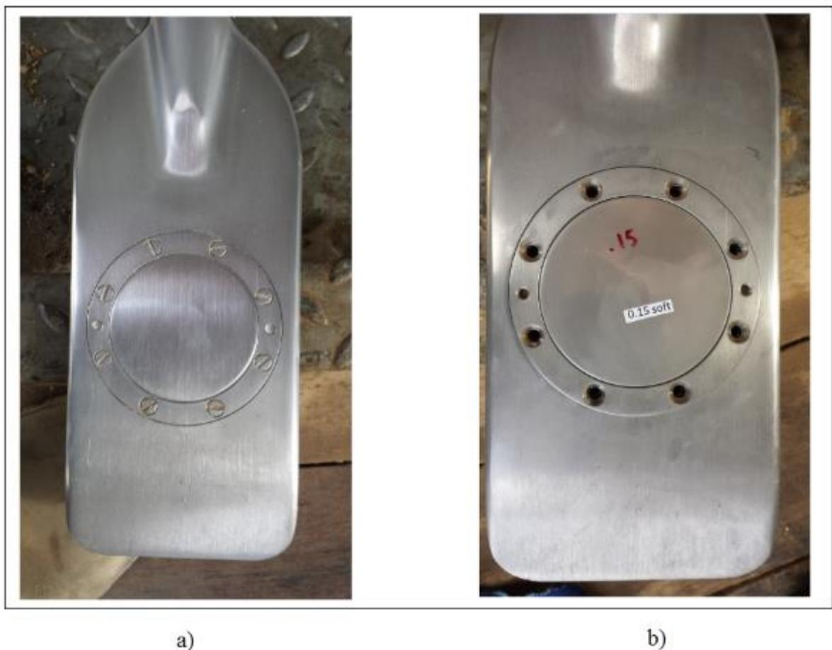
Figura 28 – a) lâmina com membrana padrão de 0,20mm;
