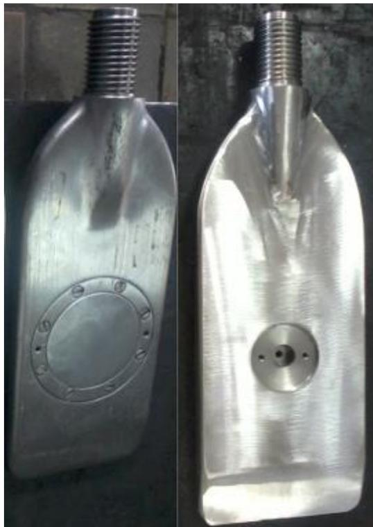
Figura 33 – Lâmina padrão DMT (esquerda) e lâmina DMTU (direita)
