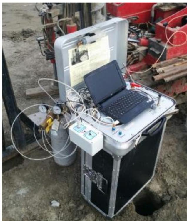
Figura 43 - Unidade controladora acoplada ao computador para aquisição de dados (DMT)
