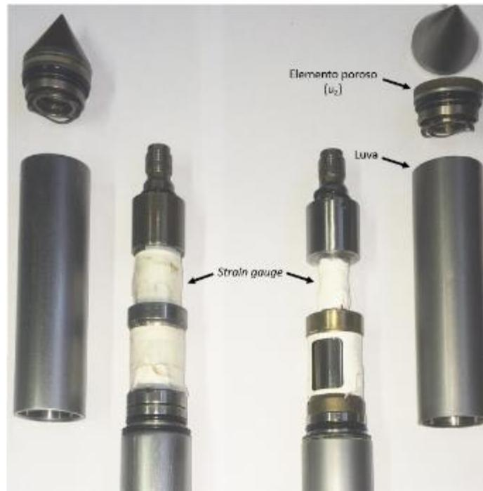
Figura 27 – Piezocones utilizados nas campanhas de investigação; esquerda: piezocone 75 kN, direita: piezocone 15 kN
