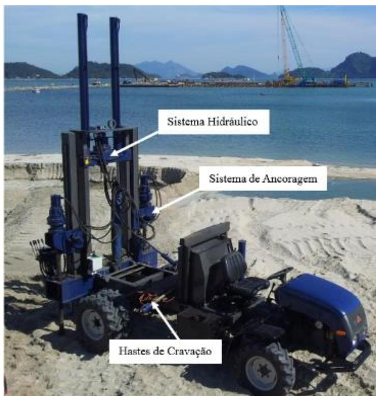
Figura 5: Sistema hidráulico montado sobre estrutura de reação
